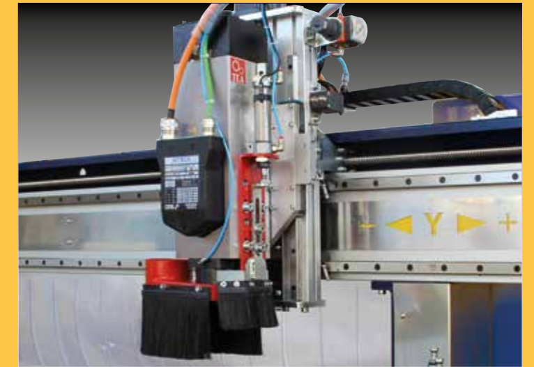
Gruppo testa con cuffia di aspirazione polveri Head assembly with dust extraction hood
